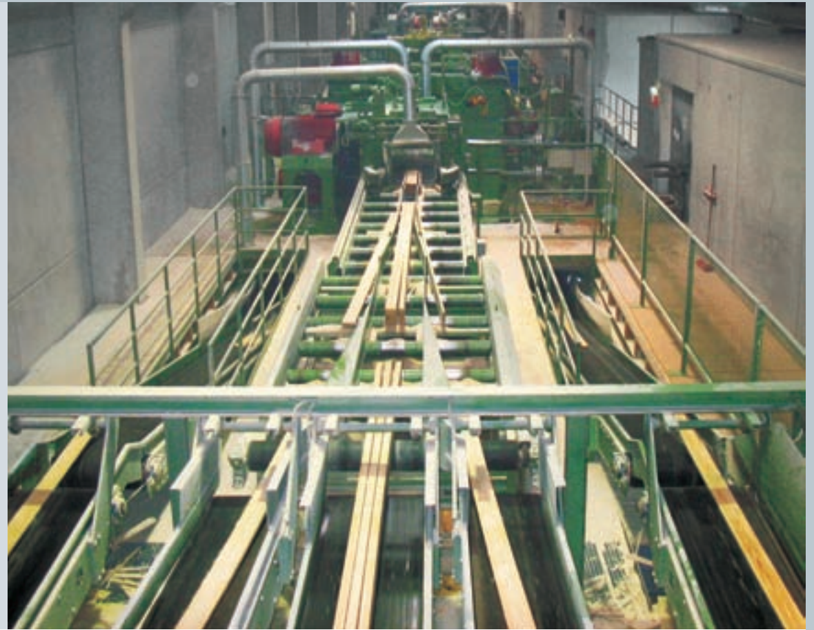
Mit modernster Zerspanertechnologie wird Schnittholz für die Herstellung von Leim-, Massivholz, Schalungsplatten oder Hobelware produziert.
