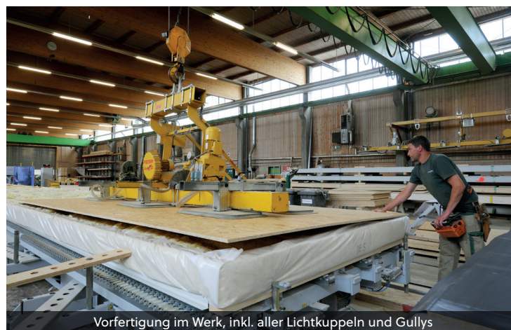
DACHHAUT 1,52 mm EPDM Dachbahn OSB Oriented Strand Board, ungeschliffene Flächpressplatte RIEGELWERK Konstruktionsvollholz technisch getrocknet 15 ± 3 % HOCHWERTIGE DÄMMUNG Mineralwolle, Hydrophobiert KLIMAMEMBRANE atmungsaktive Polyamid-Folie, WIEHAG Sonderbreite
